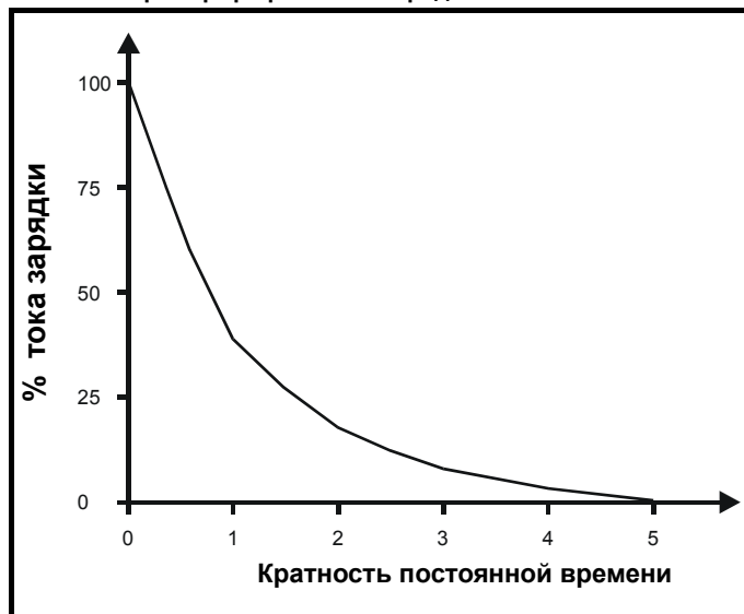
Рис.11-2 Пример графика тока зарядки
