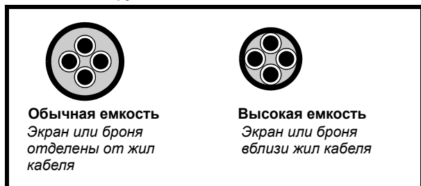
Рис. 4-7 Конструкция кабеля влияет на его емкость
