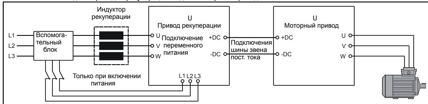
Рис. 2-2 Система с одним приводом рекуперации и одним моторным приводом
